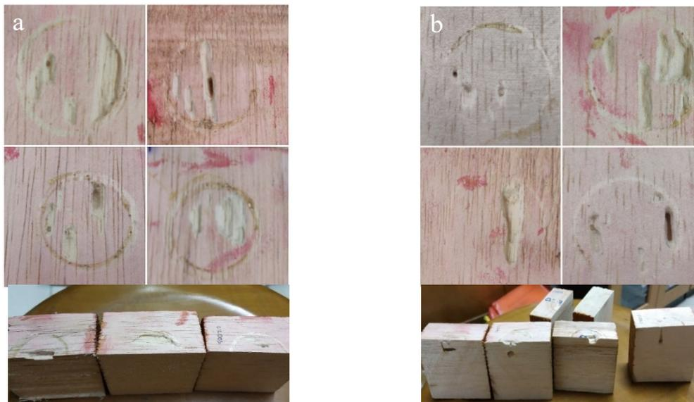
**Gambar 3. Uji serangan rayap pada sampel uji berpengawet nanokitosan dengan waktu penyimpanan (a) 0 hari (b) 7 hari**
