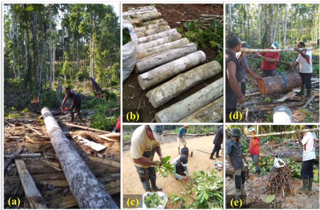
Gambar 2. Proses pengukuran pohon contoh di lapangan: (a) penebangan dan pembagian batang, (b) pemisahan sortimen batang, (c) pemisahan fraksi daun, (d) penimbangan fraksi batang, dan (e) penimbangan fraksi cabang dan ranting
